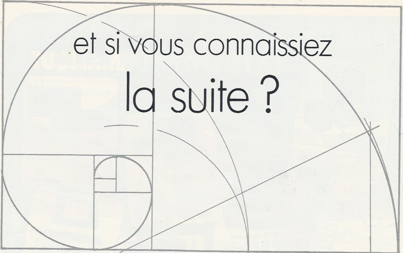
Le nombre d'or : c'est le rapport entre les longueurs des deux côtés du rectangle ci-dessus. Celui-ci est tel que, si on lui enlève un carré, le rectangle restant aura les mêmes proportions que le rectangle initial. De carré enlevé en carré enlevé, c'est en fait une véritable spirale que l'on voit apparaître.
